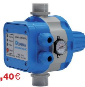
Los COMPACT KORMAN PLUS son aparatos compactos para el control automático y protección de electrobombas, cuyo sistema patentado está dotado de especiales sensores de caudal y presión integrados en un circuito electrónico que controla el funcionamiento de la electrobomba y mantiene la presión y el caudal de modo constante.
